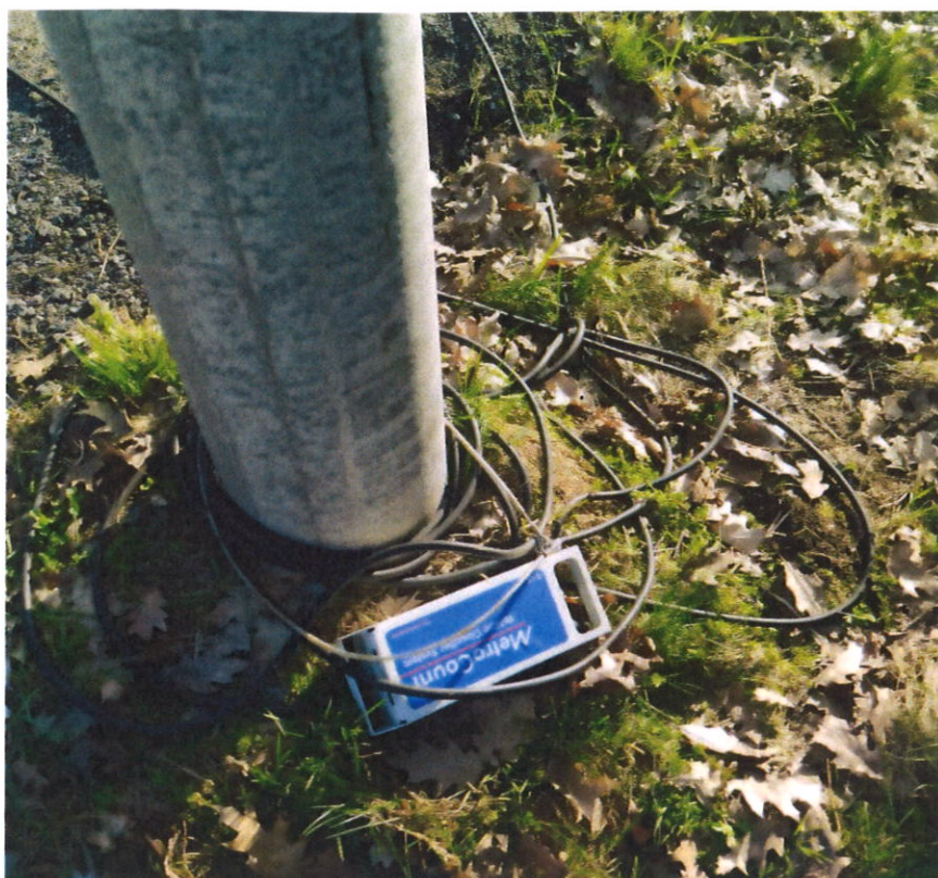
Obrázek 4: instalovaná měřicí jednotka.
